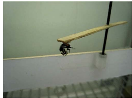
図2 フライトミルに取り付けたナミテントウ成虫。飛び始めると、その推進力でローターが回転し、その回転数をもとに一定時間あたりの飛翔距離を算出
