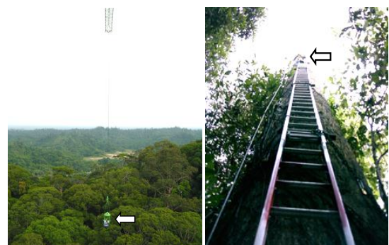
図1 森林の鉛直方向へのアクセス手法 左図：林冠クレーンとゴンドラ、右図：梯子によるアクセス（矢印は人を示す）
